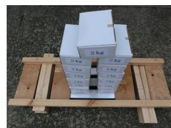
(裏面30kgf载荷状況)
