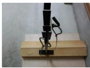
※注)アイストラップの固定ボルトナットの緩みがないか、支柱固定ボルトナットの緩みがないか確認して下さい。必要に応じて、予備ナットを用いて二重ナットにして固定して下さい。
