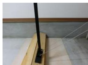
・YK金具の使用にあたっては、ワイヤー上部のワッカを支柱フックから取外し命綱等に取り付け使用して下さい。
